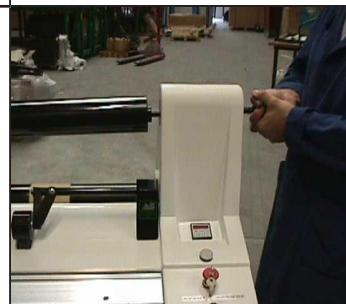
3. Dérouler manuellement le revêtement de sols pour le faire passer entre l'axe d'entraînement et l'axe presseur et le positionner à l'endroit de la coupe :
