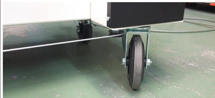
Tendre le câble de façon à ce que la machine se mette en marche lorsque le câble est écrasé au pied en partie centrale (inutile de serrer d'avantage).
